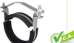
**بست پایدار پلی‌ران** به طور ویژه برای سیستم‌های کاهنده انتقال صدا طراحی شده و دارای دو نیم حلقه نامساوی است که سبب استقرار بهتر لوله و اتصالات می‌شود. طراحی منحصربه‌فرد لاستیک به کار رفته در این بست مانع از ارتعاشات ناشی از عبور جریان به سازه و محیط داخلی ساختمان می‌گردد.
