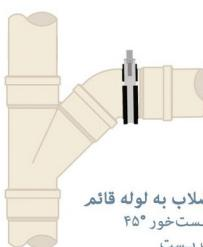
اتصال شاخه افقی فاضلاب به لوله قائم استفاده از یک زانوی بست خور ۴۵° مهار کردن محل نصب بست
