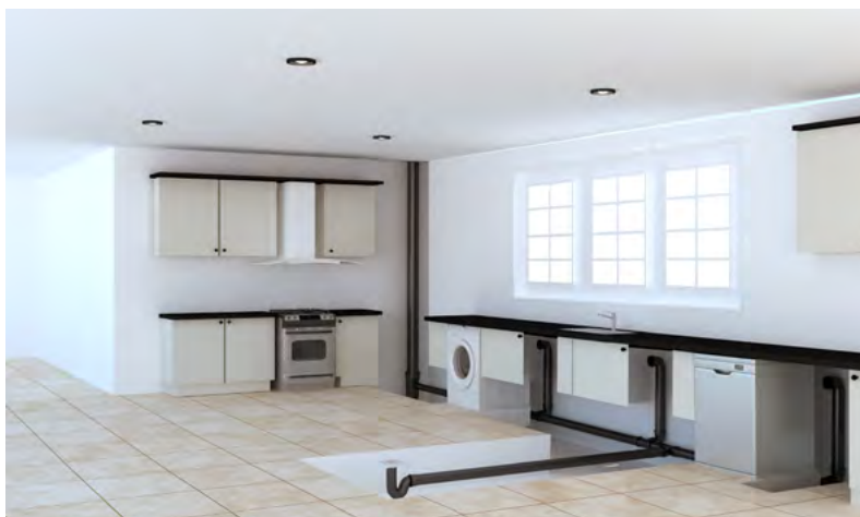
شکل ۳ نمای اجرای پلی تک در آشپزخانه
